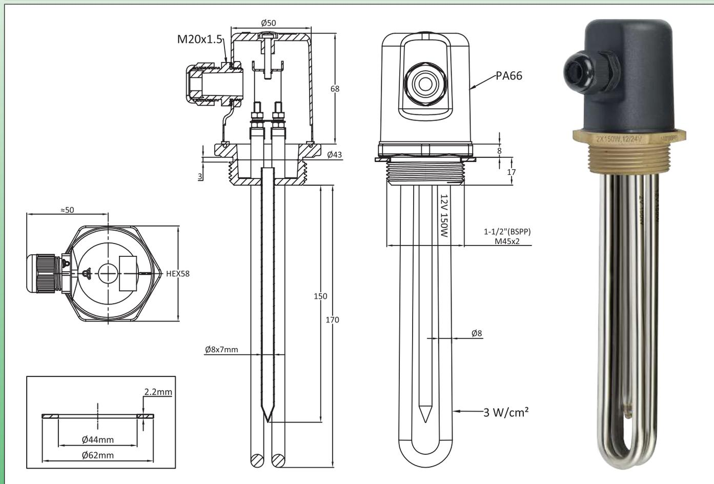
**主要用途:** 直接使用风力涡轮机或光电太阳能板产生的低电压电力，用于加热液体、家用的热水电路、热水罐。这些浸入式加热器可令其使用产生的剩余电能，并非用于家用照明所需或小型的家用电器。它们也可用于除了家用热水罐之外的电器，限制了对配电网的电力需求。
