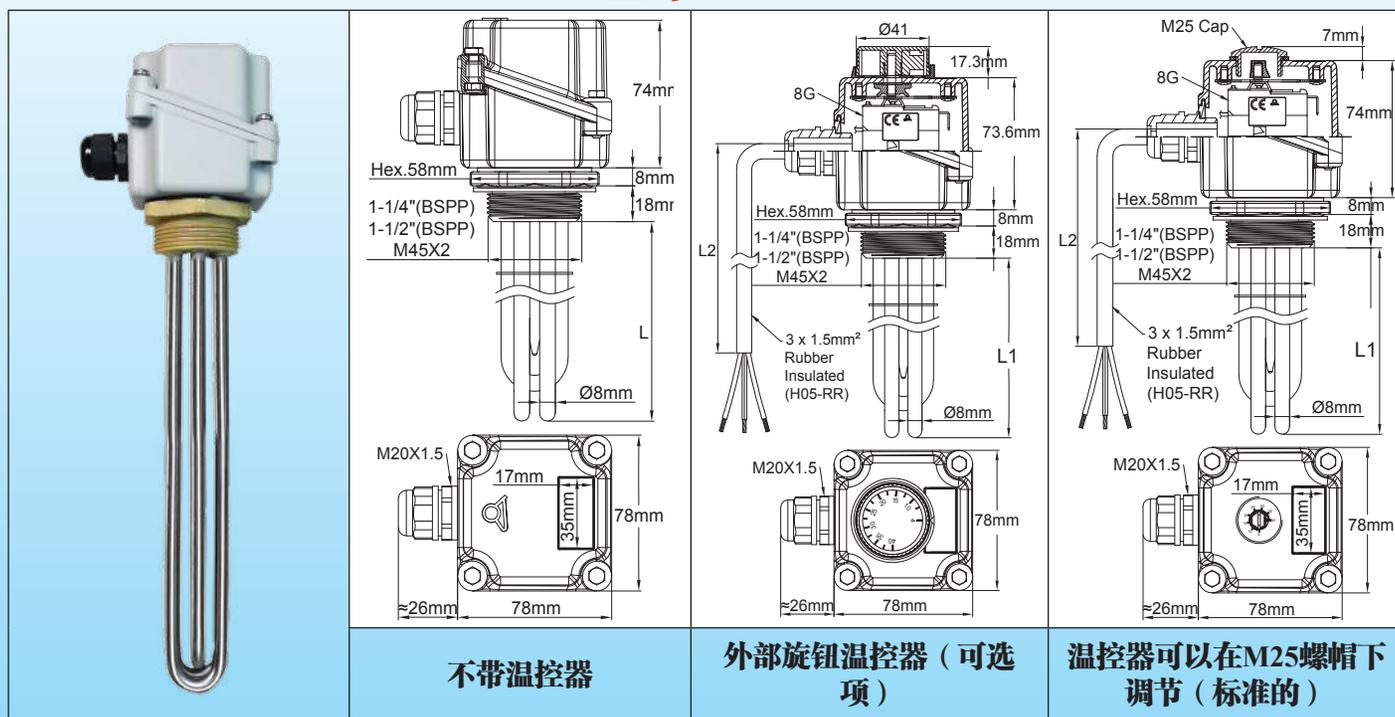
**主要的应用领域：**液体加热、热水循环、容器和缓冲罐。
