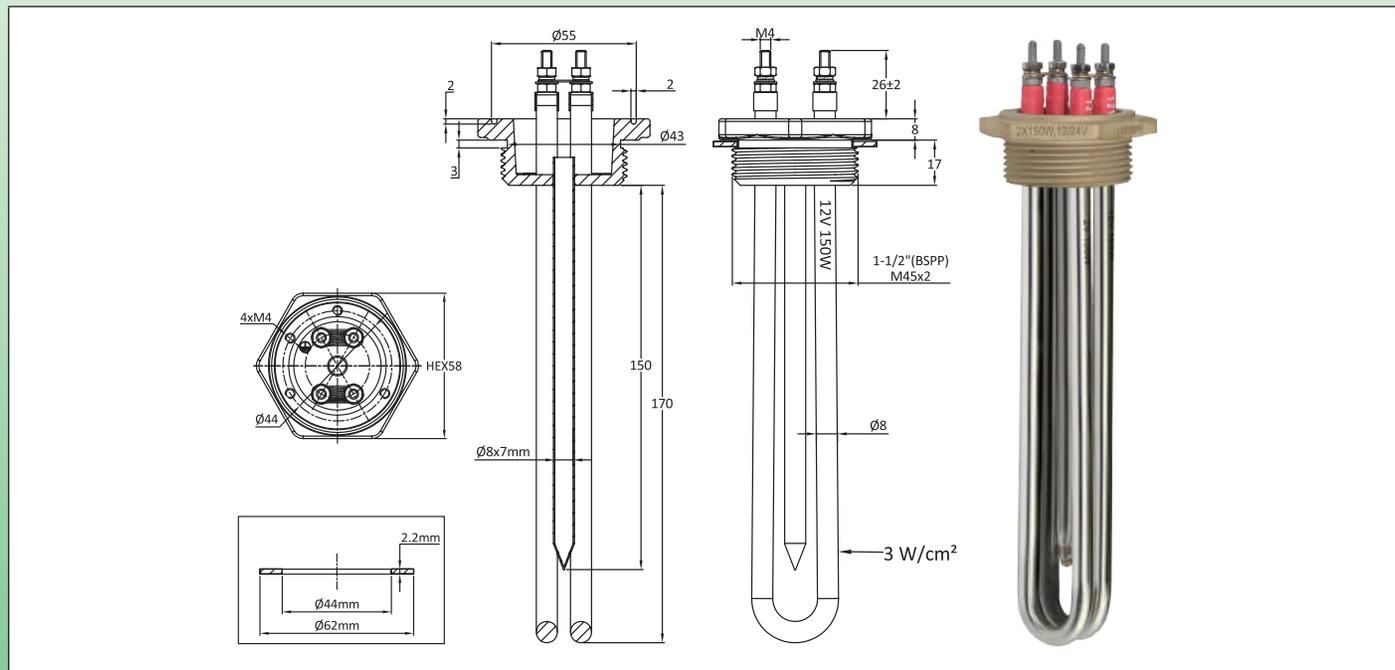
**主要用途:** 直接使用风力涡轮机或光电太阳能板产生的低电压电力，用于加热液体、家用的热水电路、热水罐。这些浸入式加热器令其可以使用产生的剩余电能，并非用于家用照明所需或小型的家用电器。它们也可用于除了家用热水罐之外的电器，限制了对配电网的电力需求。
