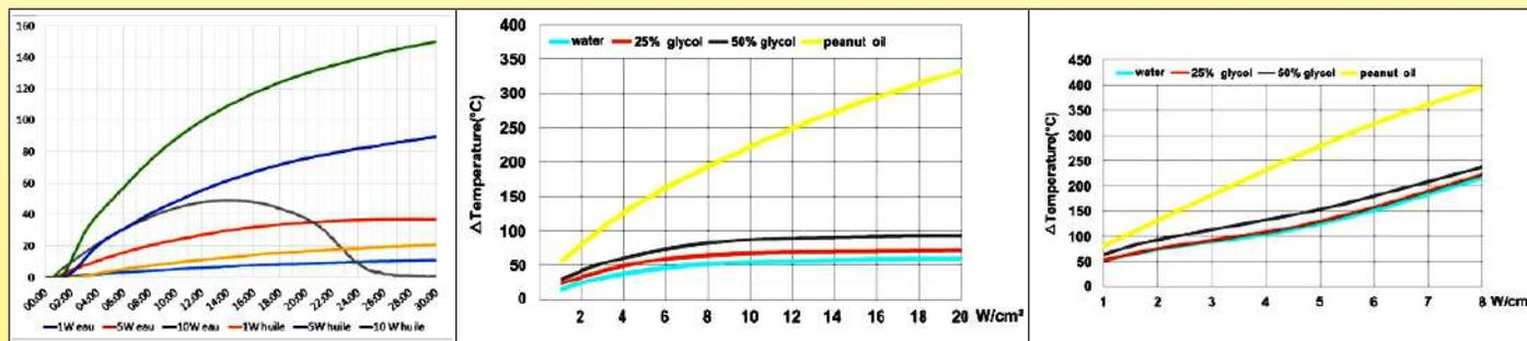
在没流量的情况下，在发热管顶部50mm的位置和发热管底部50mm位置的温度差值。可以看到巨大的温差，主要是在油里。
