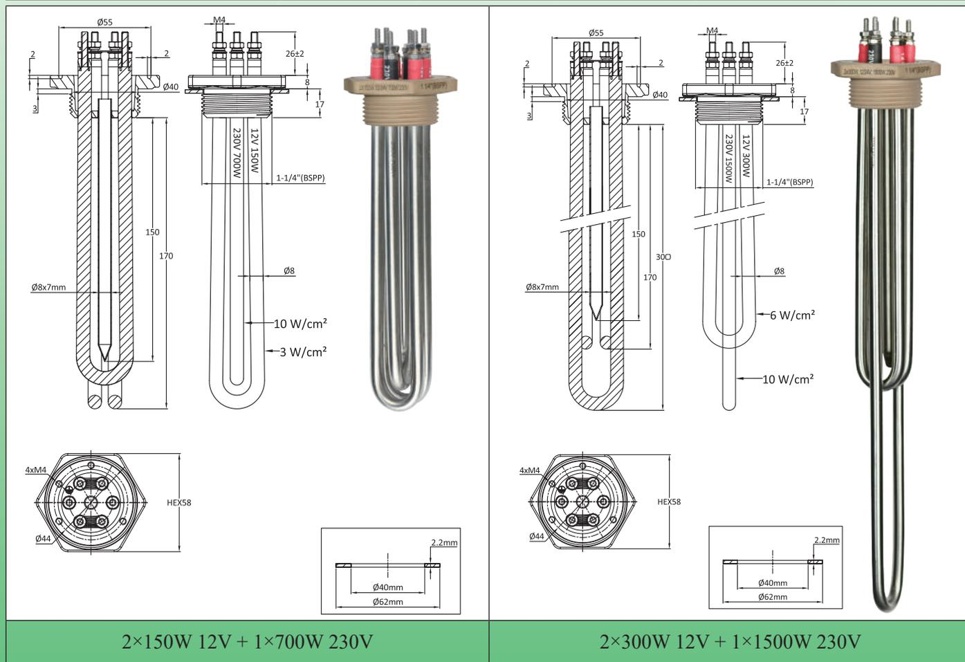
**主要应用:** 直接使用风力涡轮机或光电太阳能板产生的低电压电力，用于加热液体、家用的热水电路、热水罐。这些浸入式加热器令其可使用产生的剩余电能，并非用于家用照明所需或小型的家用电器。它们也可用于除了家用热水罐之外的电器，限制了对配电网的电力需求。
